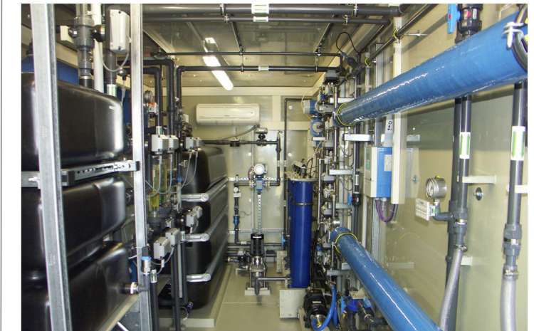
Dezentrale Trinkwassergewinnung mittels RO mit elektrochemischer Vorbehandlung ohne die Verwendung von Chemikalien. Containeranlage für Namibia.
